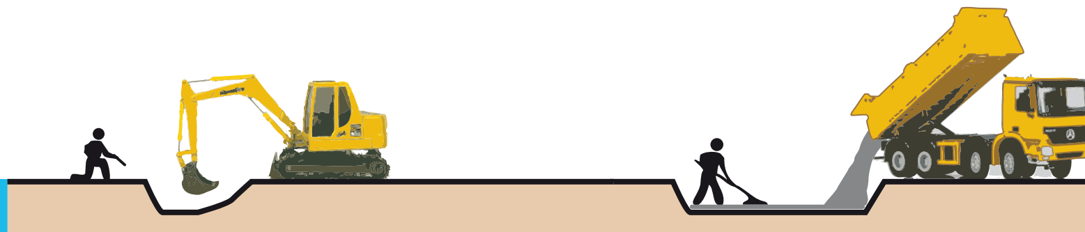
Tracciamento sagoma della piscina e scavo
