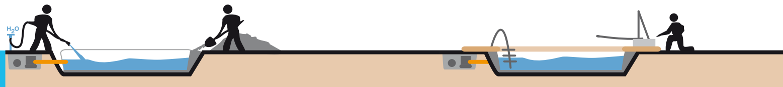
Posa ghiaia laterale e riempimento piscina
